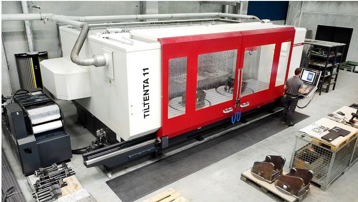
Bild 1: Mit dem 5-Achs-Bearbeitungszentrum TILTENTA 11 mit zwei integrierten NC-Rundtischen spart BL Lasertechnik pro Bauteil rund 15 Minuten Rüstzeit ein.
