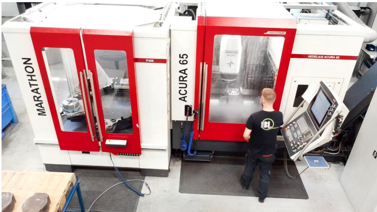
Bild 2: Perfekt abgestimmt: Die ACURA 65 wird durch die Palettenautomation MARATHON PL406 voll automatisiert von der Seite beladen.
